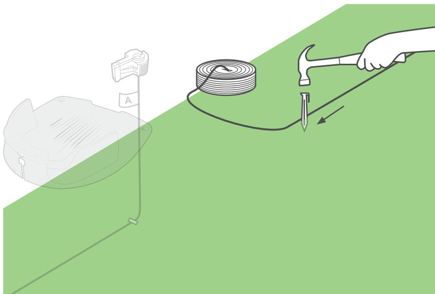
Faites en sorte que les deux extrémités de câble soient de la même longueur. Utilisez une pince coupante pour couper le câble en surplus. Ne laissez pas traîner de câble enroulé.
