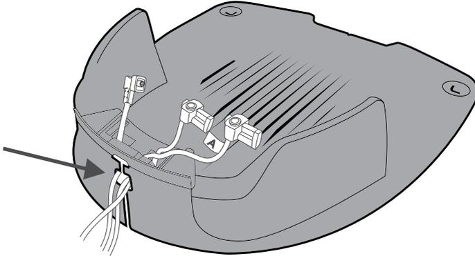
2. Connectez l'extrémité du câble marquée A à la borne A et l'autre extrémité à la borne B de la tête de la station.
